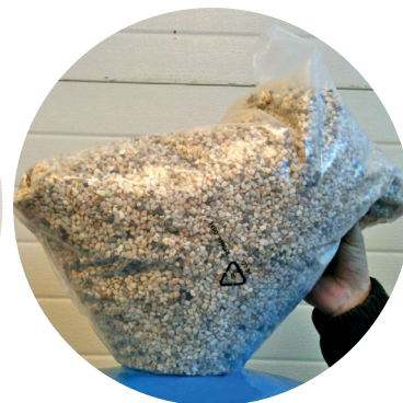
4 : Charger le silex puis le sable puis les médias filtrants du + lourd au + léger
